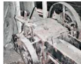
Die Treibräder der Rinden-aufbereitungsmaschine
